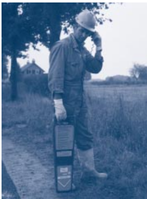
Controle op aanwezigheid van kabels en leidingen
